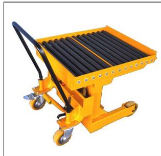
Werkzeugwechselwagen mit Rollenbahn
